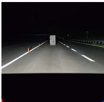
上の写真は、前方40メートルの位置に置いた障害物 (※) を、最新型のヘッドライトを使い、上向き（左）・下向き（右）で照射したときの様子です。下向きライトでは障害物は闇に紛れて視認できません。
