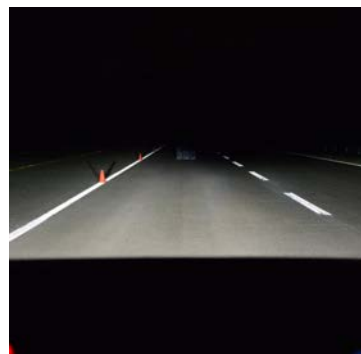
上の写真は、前方40メートルの位置に置いた障害物 (※) を、最新型のヘッドライトを使い、上向き（左）・下向き（右）で照射したときの様子です。下向きライトでは障害物は闇に紛れて視認できません。
