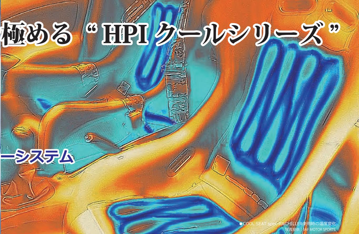
●COOL SEAT spec-R&C CHILLER使用時の温度変化
